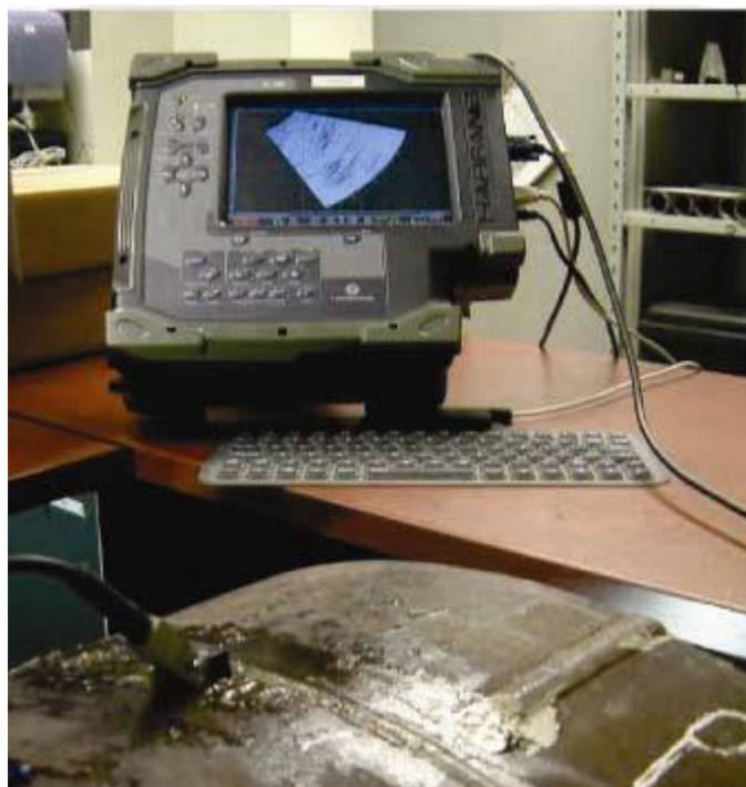
شکل ۱۶: استفاده از PAUT در بازرسی جوش لوله ها
